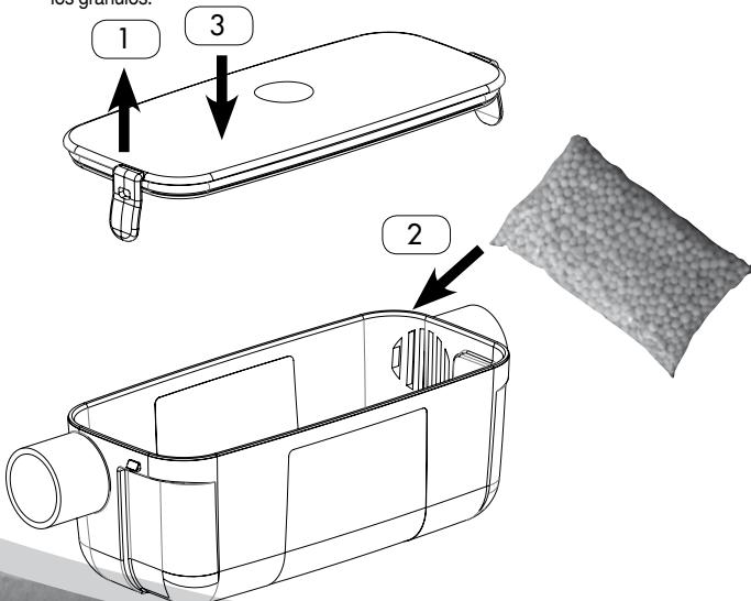
**[NL]** Controleer regelmatig de conditie van de granulaatkorrels. Het niveau van de granulaatkorrels dient boven het minimum niveau te zijn zoals aangegeven op het productetiket. De granulaatkorrels jaarlijks vernieuwen. Bij het vervangen van de granulaatkorrels de neutralisator schoonmaken.
